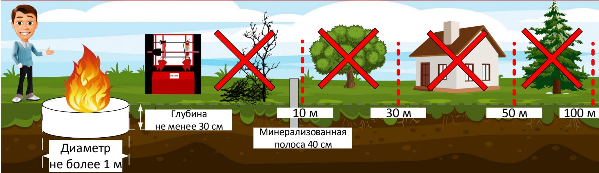
Место использования открытого огня – в виде котлована (ямы, рва) **не менее чем 0,3 м глубиной** и **не более 1 м в диаметре** или площадки с прочно установленной на ней металлической емкостью (например, бочка, бак, мангал) или емкостью, выполненной из иных негорючих материалов, (при этом исключается возможность распространения пламени и выпадения сгораемых материалов за пределы очага горения) **объемом не более 1 м куб.**
